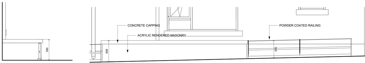
**TYPICAL PLANTER AND FRONT RAILING DETAIL**
